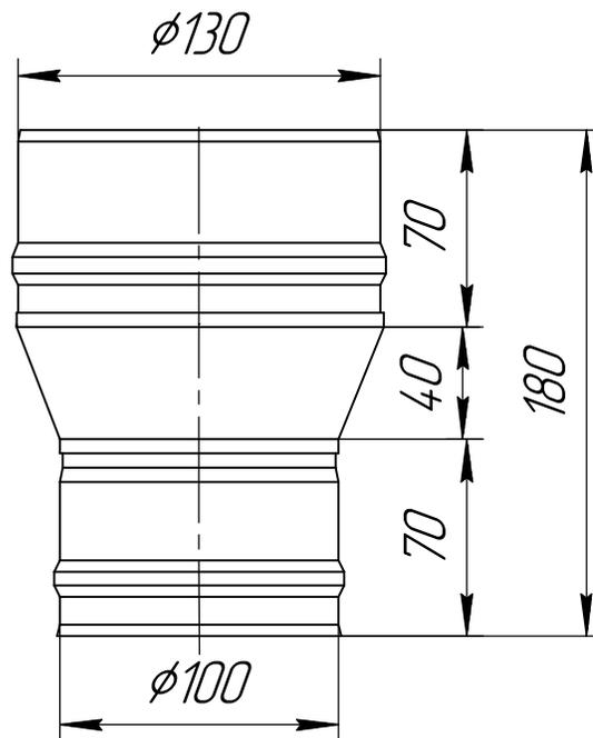
1. При сборке изделия, откатанные пояски конической детали ,привариваются на внешней стороне обечайки составляющей частей.
